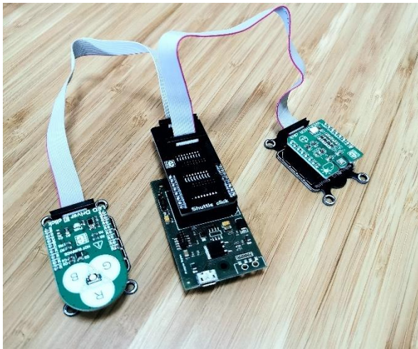
fig. 26: Collegamento della sensoristica
